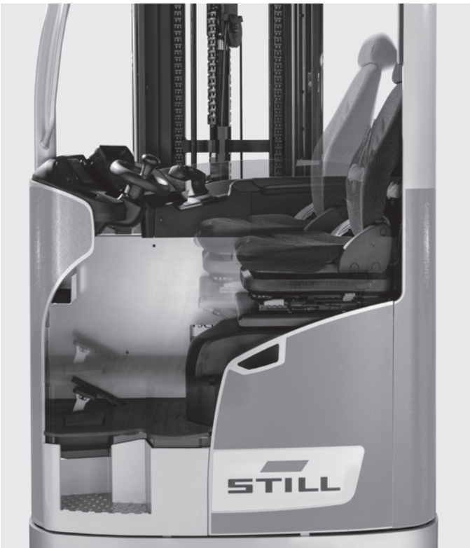
Koltuğun ve taban plakasının oransal ayarlaması sayesinde ergonomik olarak optimal pozisyon
